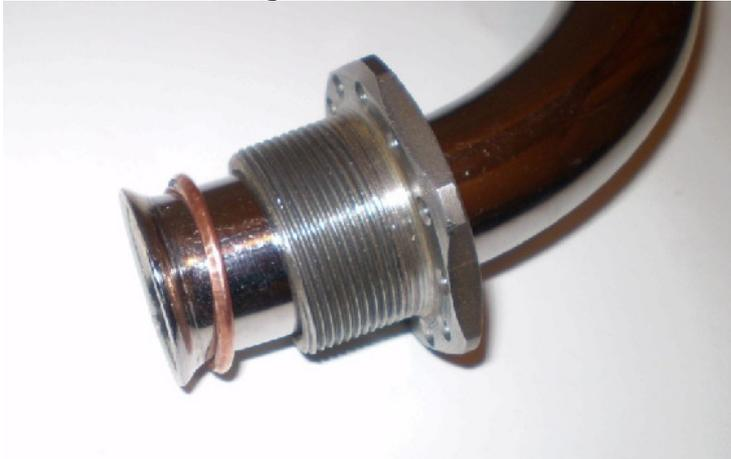
Legen Sie den Quetschring zwischen die sich passenden Flächen des Auspuffkrümmers und des Zylinderstutzens:
