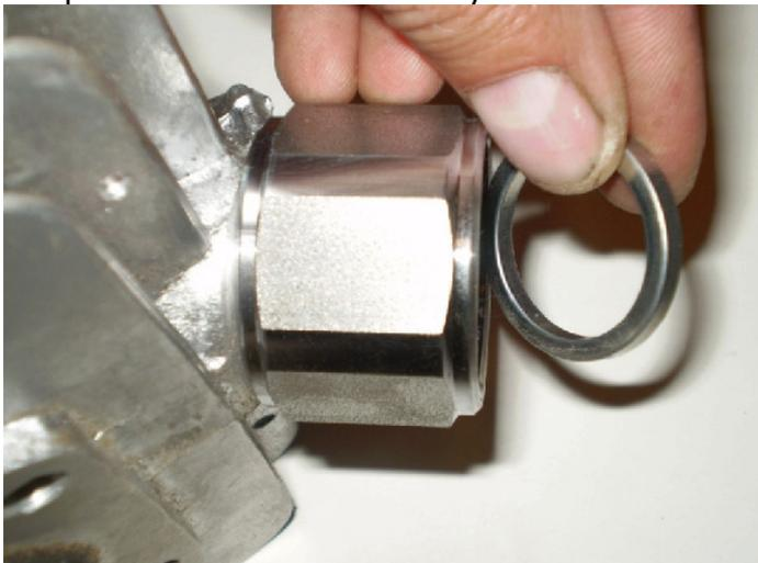
Schrauben Sie das System mit einem Anzugsdrehmoment von ca. 25 Nm zusammen, so, dass 2 Bohrungen aus den 12 Bohrungen *der Überwurfmutter* mit der auf dem Zylinder fertig gestellten Sicherungsbohrungen in einer Linie, in Flucht liegen.
