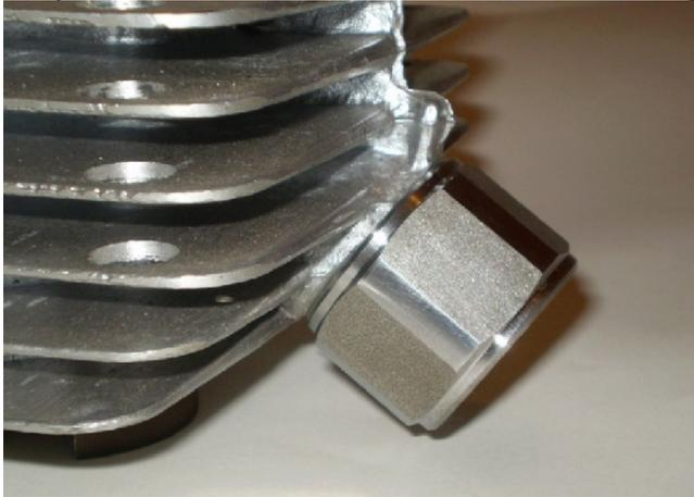
Schieben Sie zuerst den Kupferdichtring auf den Auspuffkrümmer Ø28mm auf (die Quetschfläche liegt in Richtung des breiteren Endes des Krümmers), dann schieben Sie die große Überwurfmutter über den Krümmer:
