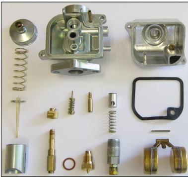
Originalvergaser demontieren und Einzelteile gründlich reinigen. Der Zerstäuber sollte mit einem runden Dorn Ø 6,1 mm von unten vorsichtig aus dem Vergaser getrieben werden. Verschlissene Teile wie z.B. der Gasschieber sollten durch Neuteile ersetzt werden. Düsenstock, Nadeldüse und Nadel werden nicht mehr benötigt.
