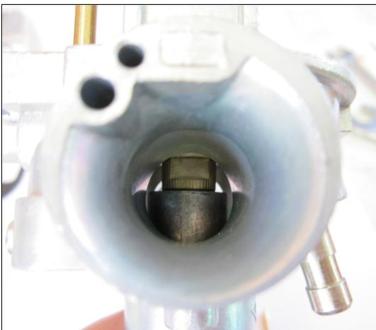
Den mitgelieferten Zerstäuber mit Hilfe einer 7er / 8er Nuss bzw. einer Hülse mit 7,2 mm Innendurchmesser und 15 mm Außendurchmesser in den Vergaser drücken. Dabei muss unbedingt die Einbauposition beachtet werden. Die Abschrägung am Zerstäuber muss rechtwinklig zum Ansaugtrichter / Luftfilterkasten zeigen(siehe Foto).
