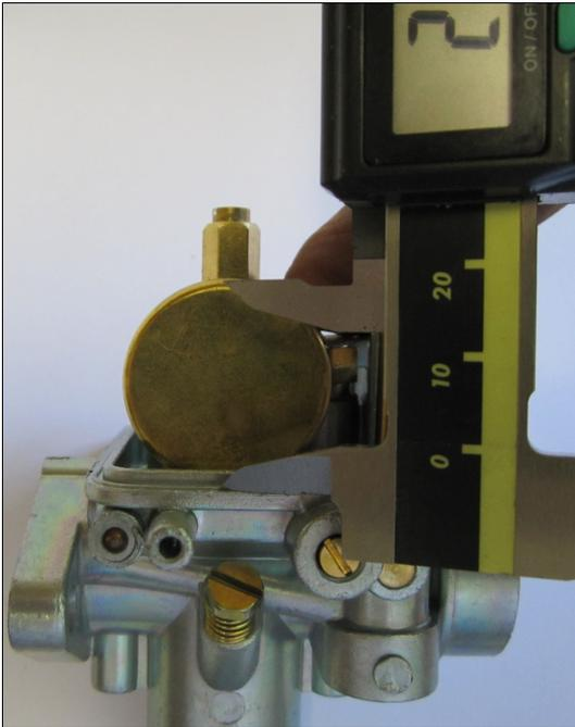
Einlassventil einbauen und anschließend den Schwimmerstand (Dichfläche der Vergaserwanne bis Unterkante Schwimmerblase) einstellen. Für den geschlossenen Zustand die Schwimmerblasen vorsichtig und gleichmäßig biegen. Die maximale Öffnung reguliert man mit Hilfe des Anschlagbleches am Schwimmerbolzenhalter.
