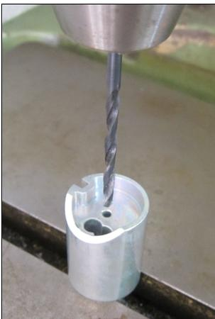
Durchgangsbohrung für die Nadel im Gasschieber auf 2,6 - 2,7 mm aufbohren.
